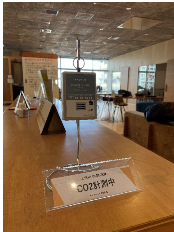
執務空間内に設置した温度・湿度・二酸化炭素の計測センサー
