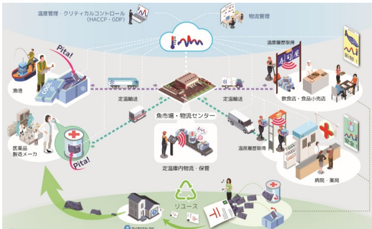
図7 有機半導体温度/振動センサを用いた長寿命リユース型無線物流トレースフィルムの実証実験を実施した、エコフレンドリーかつ低コストのリユース型物流トレースシステム。
